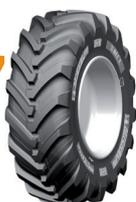
Le MICHELIN XMCL offre une très grande résistance à l'usure grâce à un mélange de gomme robuste, parfaitement résistant aux phénomènes de rippage. Sa bande de roulement lui assure une excellente motricité et capacité de traction sur les sols meubles.
