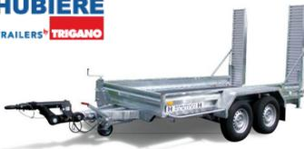
Châssis mécano soudé, galvanisé à chaud. Ridelles monocoques. Garde-boue démontables. Rampes aluminium réglables en largeur. Timon réglable en hauteur à double articulation BASIC. Attelage à anneau 68 x 42. Éclairage code européen encastré. Frein à inertie avec recul automatique. Plancher bois toute largeur. Points d'ancrage. Roue jockey de forte section démontable. Béquilles arrière de chargement automatiques.
